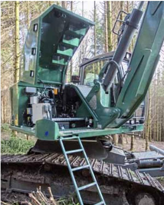
**Der Oberwagen ist stark komprimiert und gewährleistet minimalen Überstand übers Fahrwerk**
